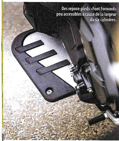
Des repose-pieds «Foot Forward» peu accessibles à cause de la largeur du six cylindres.
